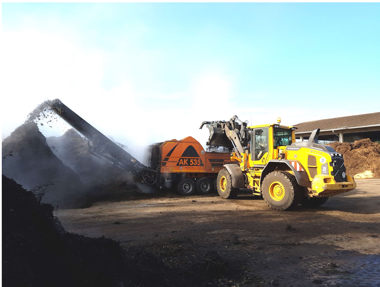
Radlader beim Befüllen der Siebanlage
