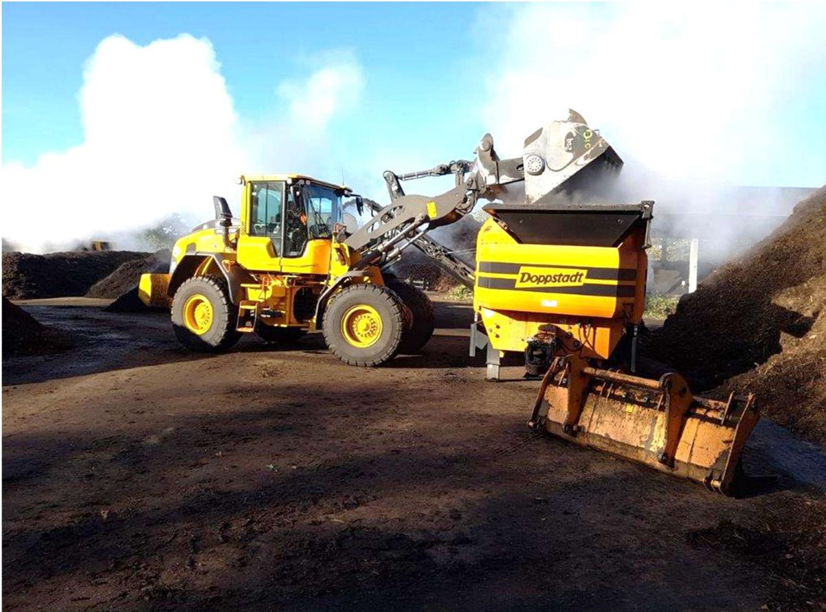
Befüllen der Siebanlage in der Kompostierung
