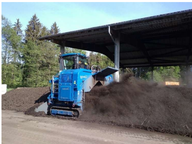
Kompostwendemaschine in Eiselfing
